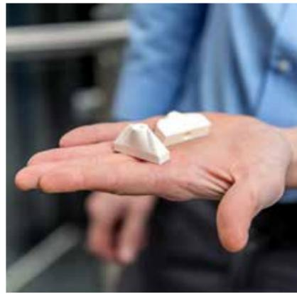
Leicht und handlich sind die im 3D-Druckverfahren hergestellten keramischen Elemente.
