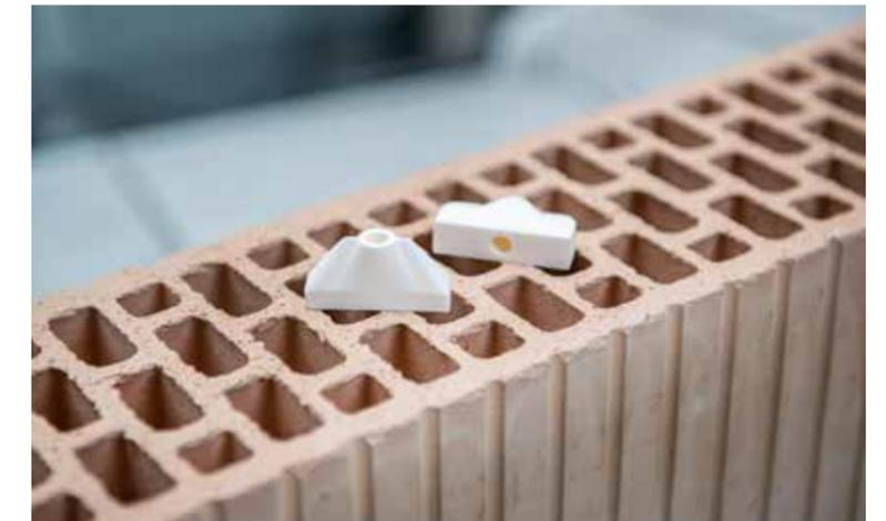
Kleine Keramik-Elemente werden individuell gedruckt und dann in bestehende Presswerkzeuge eingesetzt.
