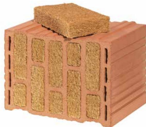
Mit einer Wärmeleitfähigkeit LambdaR von nur 0,08 W/(mK) und einem Wärmedurchgangskoeffizient (U-Wert) bis zu 0,18 W/(m<sup>2</sup>K) je nach Wandstärke (24,0 bis 49,0 cm) zählt der neue MZ80-GH zu den thermisch wirkungsvollsten Mauerziegeln in Deutschland – sowohl beim winterlichen als auch sommerlichen Wärmeschutz.
